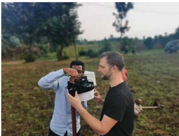
Installation d'une station météo au Rwanda
